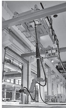
Рис. 9. Ограниченно подвижный мостовой НРТК Blastman
