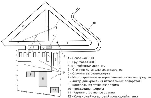
*Рис. 1.* Типовая схема аэродрома
