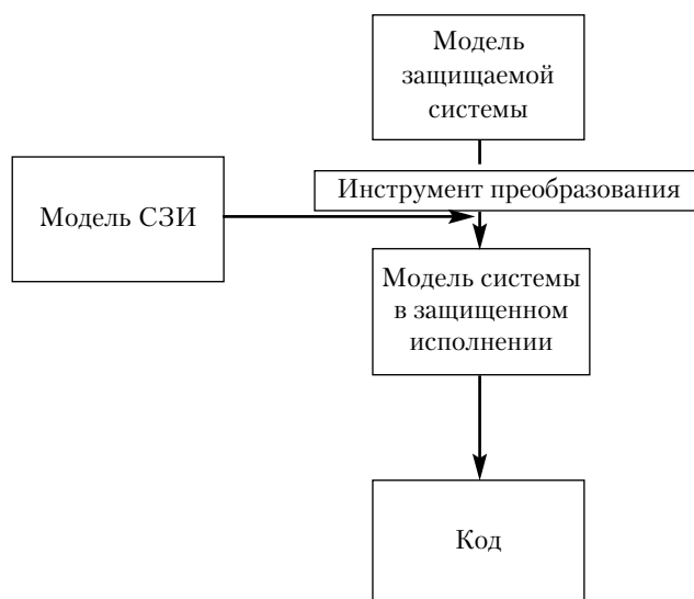
Рис. 1. Создание системы в защищенном исполнении
